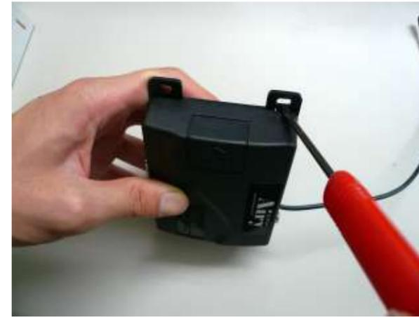
①受信機のケースを外します。4 箇所のツメで留めているので精密のマイナスドライバーを写真のように入れ開けます。
