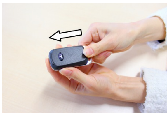
①裏面のカバーをスライドさせて外します。
