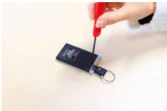
①裏面の電池カバーのビスを外します。
