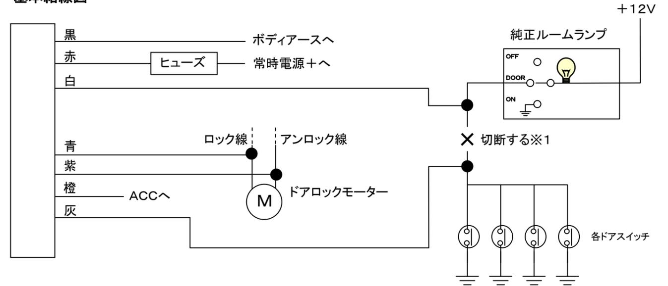
※1必ずルームランプコネクタのすぐ後で切断して下さい。切断場所によっては、純正キーレスが作動しなくなります。また、切断後ルームランプ側、車両側に十分注意して配線を接続して下さい。間違えると、ヒューズが飛んだり、キットや車両が故障する可能性があります。
