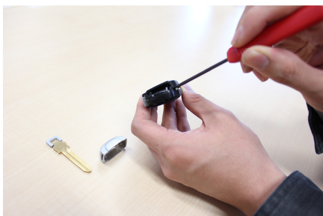
③黒いカバーの隙間にマイナスドライバーを挿し込み、カバーを開けます。
