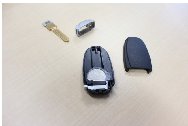
④透明の電池カバーを外して電池を交換してします。
