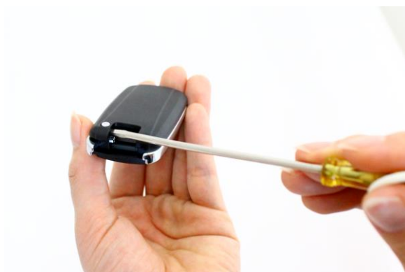
③左側の隙間も同じように差し込み、浮かせて外します。
