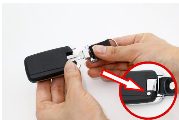
①丸い金属部分を押し、エマージェンシーキー装着部を外します。
