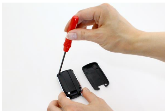
④カバーを外した後、ネジを4箇所外します。
