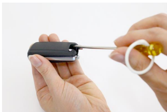
②リモコン右側の隙間にマイナスドライバー等を差し込み浮かせます。
