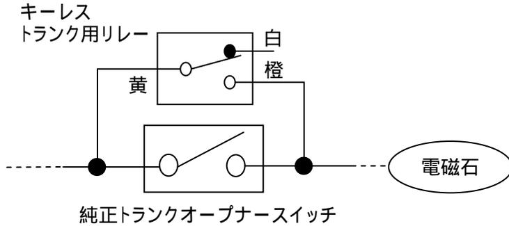
受信機を接続する前に必ずキーレスに付属している検査ピンで配線検査をしてください。
