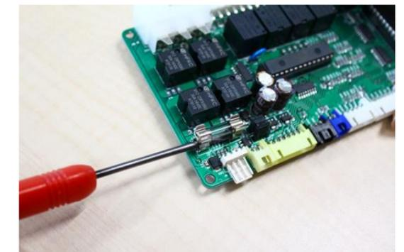
ソニックスタート基板の上に回路を保護する目的の管ヒューズが付いています。このヒューズはCN3、CN5、CN6、CN8、CN9、CN12、CN13の赤線がショートした場合や、200mA以上の電流が流れた場合に飛びます。スマートモジュールやセンサー、イモビキャンセラー等が反応しないという症状の場合、このヒューズをご確認下さい。ヒューズの確認や交換は、必ず全てのコネクタを抜いた状態で行い、ヒューズの下に隙間に小さいマイナスドライバーを挿し込み、優しく外して下さい。
