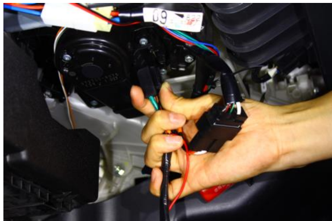
②抜いたコネクタにメインハーネスのコネクタを接続し、ブローファンにも反対側のコネクタを接続します。
