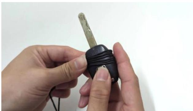
3. 片方は時計回り、もう片方は反時計回りになるようにキーにハーネスを巻き付けます。
