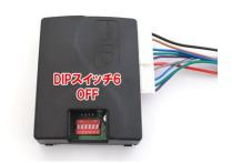
② CN1ハーネスを接続した状態で、DIP スイッ チ6を OFF にします。
