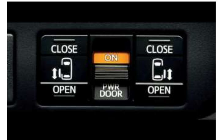
室内のスライドドアスイッチ
